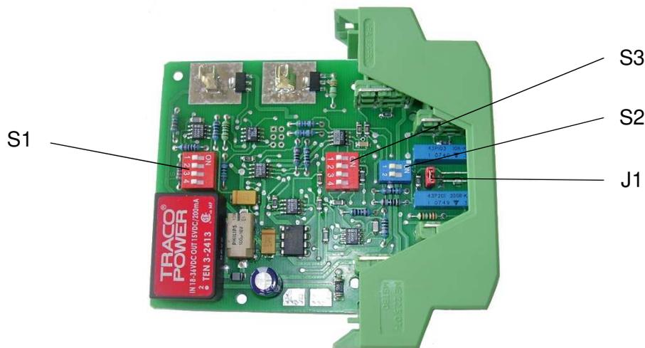
Рис. 2. Расположение перемычки и DIP-переключателей на плате преобразователя
