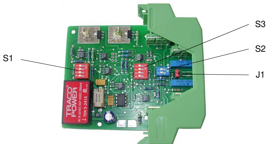
Obr. 2 Umiestnenie prepíjky a DIP prepínačov na doske prevodníka
